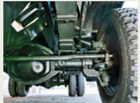
Harte Fakten: Vorne und hinten Starrachsen an Blattfedern.
